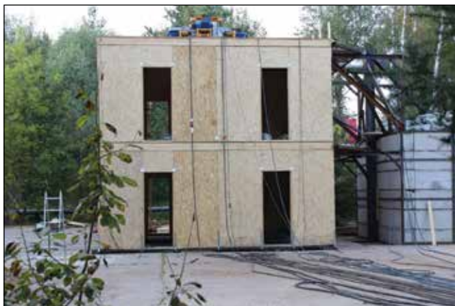
Рисунок 1 — Фрагмент здания, подвергнутого динамическому воздействию от вибромашины инерционного действия ВИД 12/19М [5]
