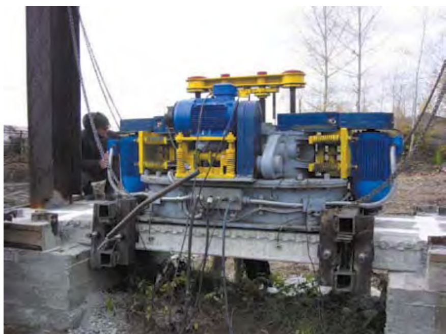
Рис.3. Схема и стенд для динамических испытаний стыков соединений плит: схема испытаний и ее реализация на стенде для испытаний
