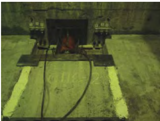
Рис.2. Схема и стенд для испытаний поперечного стыка на сдвиг: расчетная схема и стенд для испытаний (фотофиксация)
