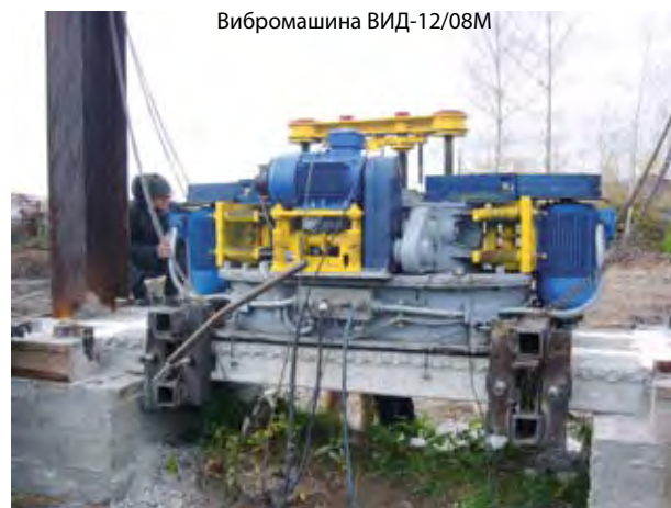
Рис.4. Схема и стенд для динамических испытаний продольных стыков
