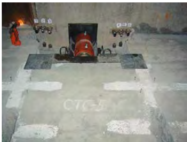
Рис.3. Схема и стенд для статических испытаний продольных стыков
