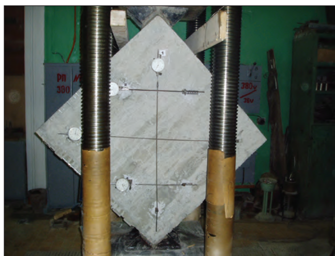
Рис. 11. Кирпичный образец, усиленный с помощью СНО
