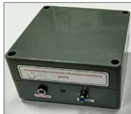
Рисунок 1 – Внешний вид ИНСК – трехкомпонентного цифрового акселерометра измерения низкочастотных сейсмических колебаний
