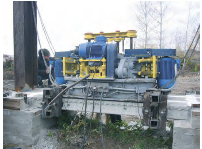
Рис.5. Испытания плит перекрытий беспалубочного формования. РА, Горно-Алтайск, 2010
