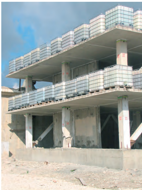
Рис.2. Испытания 2-этажного фрагмента здания системы «КУБ-2.5». Москва, 2008
