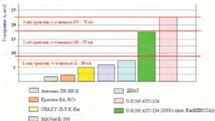
Рис.4. Сравнительный анализ действующих нагрузок (ускорений) на НФС с облицовкой из керамогранита при динамических испытаниях (8 баллов), для уровней установки на объекте
