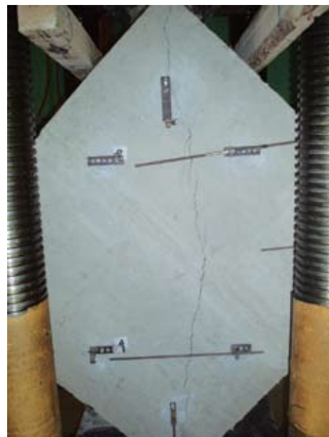
Рис.9. Разрушение эталонных образцов серии ОК-3
