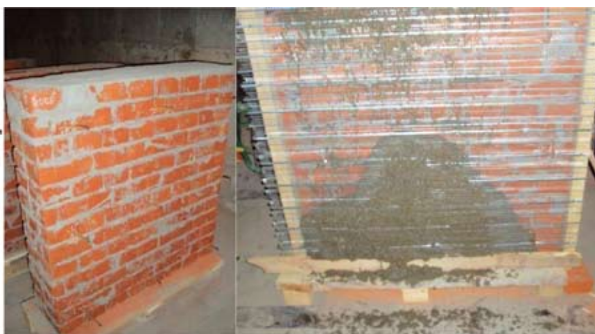
Рис.1. Принципы усиления кирпичной кладки СНО
