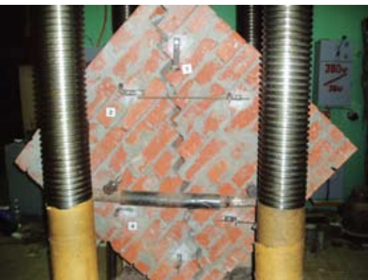
Рис.7. Разрушение эталонных образцов серии ОК-1
