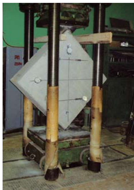
Рис.6. Общий вид установки образцов в пресс для испытания
