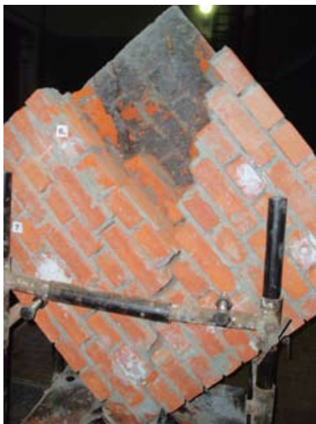
Рис.8. Разрушение эталонных образцов серии ОК-2
