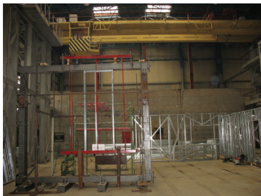
Рис.10. Результаты фотофиксации определения критической нагрузки на стеновую панель
