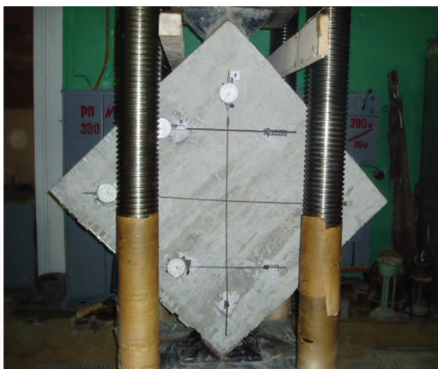
Рис.11. Кирпичный образец, усиленный с помощью СНО
