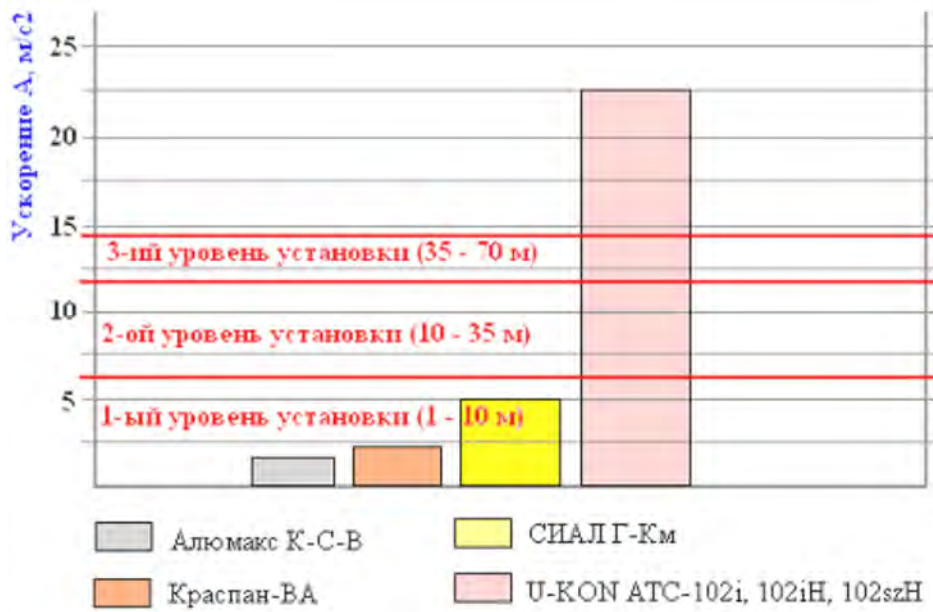
Рисунок 6 – Сравнительный анализ действующих нагрузок (ускорений) на НФС с облицовкой из композита при динамических испытаниях (8 баллов), для уровней установки на объекте
