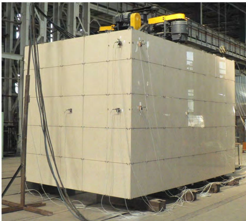
Рисунок 3 – Вибростенд со смонтированной НВФС и источником вибраций (вибромашина инерционного действия (типа ВИД-12/08))
