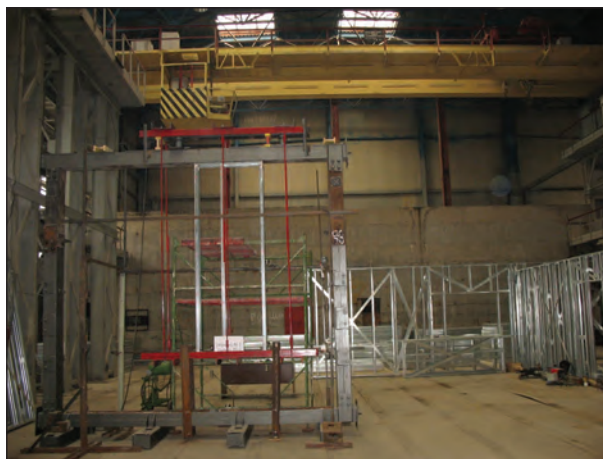
Рис. 10. Результаты фотофиксации определения критической нагрузки на стеновую панель
