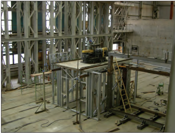
Рис. 9. Испытание фрагмента здания с применением вибромашины ВИД-12
