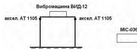
Рис. 5. Схема проведения динамического эксперимента
