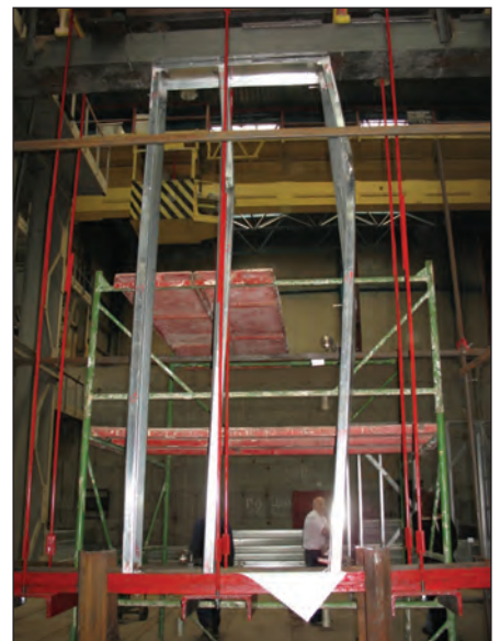
Рис. 10. Результаты фотофиксации определения критической нагрузки на стеновую панель
